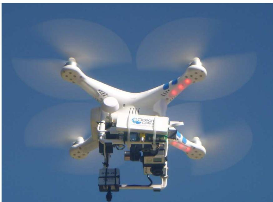
Рис. 2. БПЛА с установленным спектрометром
