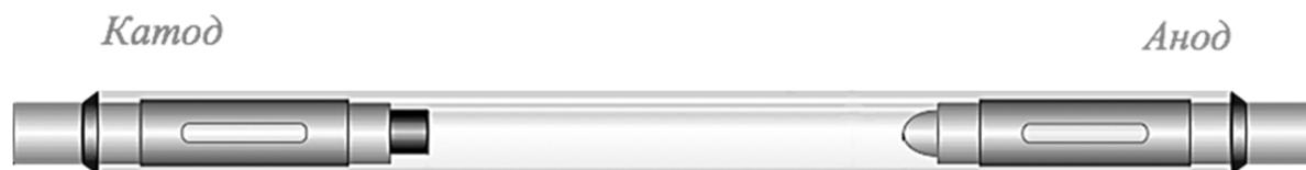
Эскиз импульсной лампы прямой накачки
