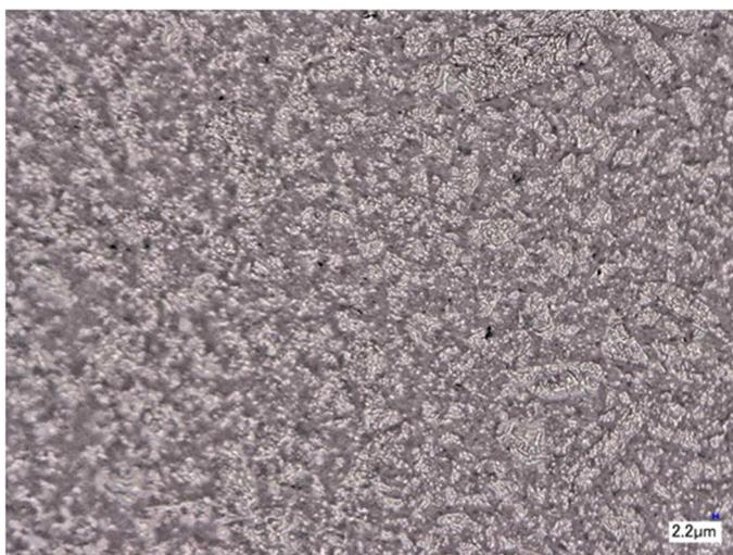
Снимок поверхности образца корундовой керамики, сделанный на электронном микроскопе
