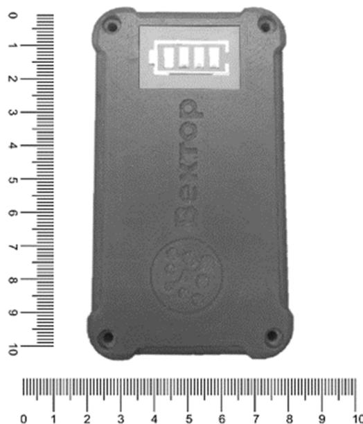
Рис. 2. Внешний вид опытного образца адаптера беспроводной сети
