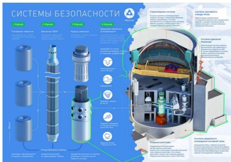
Рис. 2. Система безопасности на АЭС
